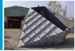
GAZ KANALI İMALATI
